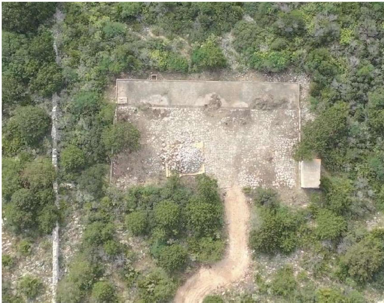
Siamo di fronte ad un interessantissimo e raro manufatto, evidentemente non sufficientemente studiato e opportunamente interpretato; è il caso di una cisterna (m.25x5 circa) per la raccolta e deposito dell'acqua dolce per vari usi dotata di un ampio (m.25x15 circa) vespaio di captazione delle acque di pioggia diretta ma anche quelle di trenaggio dal terreno circostante e ancora di condensa dell'umidità atmosferica.
